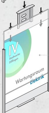
2 Das Papier einlegen und die Abdeckung sowie die Halterung wieder aufsetzen.
